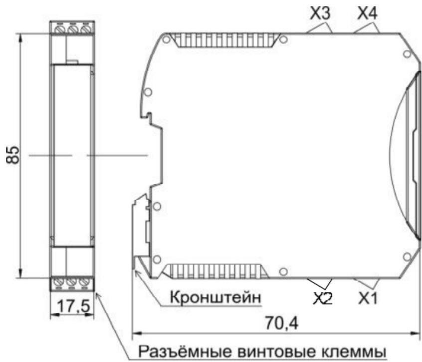
Рисунок 8 – Габаритные размеры преобразователя
