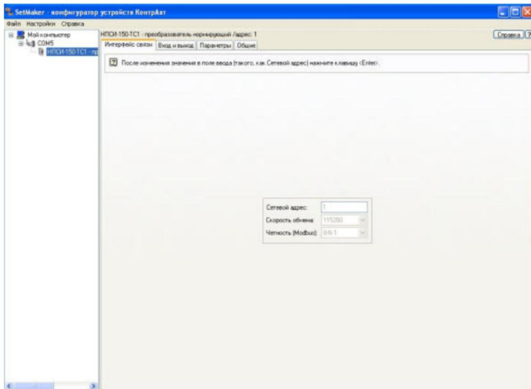
Рисунок 3 – Окно конфигурирования преобразователя, вкладка «Интерфейс связи»
