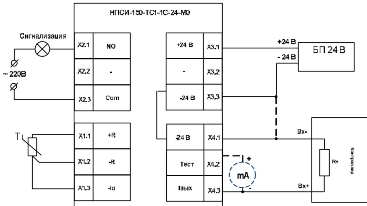
Рисунок 9 – Схема подключения преобразователей НПСИ-150-ТС1-1С-24-М0
